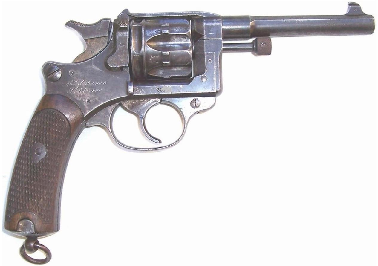
Dans le but d'offrir une arme plus moderne aux officiers pour remplacer le modèle 1874, il est demandé l'étude d'un nouveau revolver en 1885. Après de nombreuses tergiversations ce fut le revolver en calibre 8 mm, chargé à la poudre sans fumée, qui fut adopté et construit exclusivement par la M.A.S.
