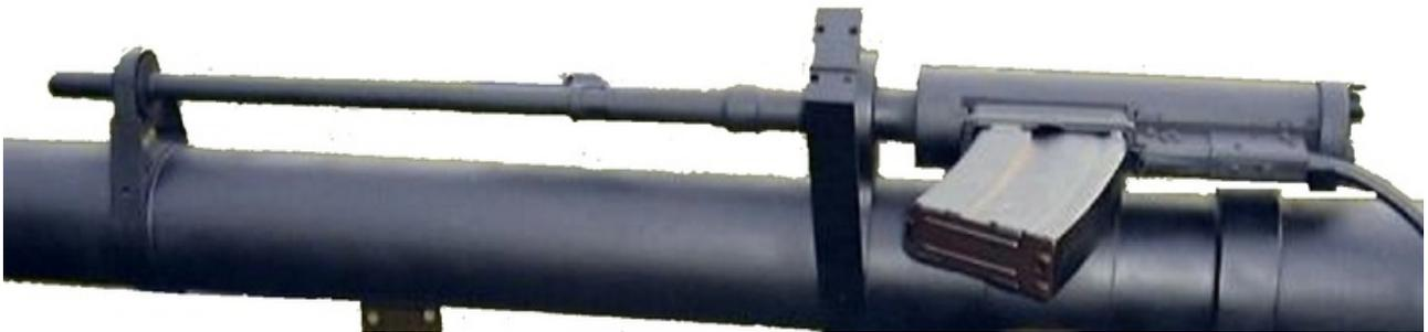
**Le rifle spotting M8 C avec le chargeur de 20 cartouches, monté sur le canon de 106 mm.**
