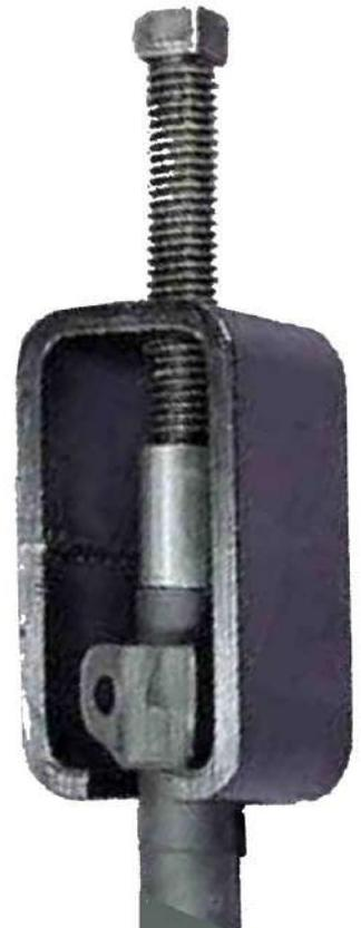
Appareil de dépose du guidon.
