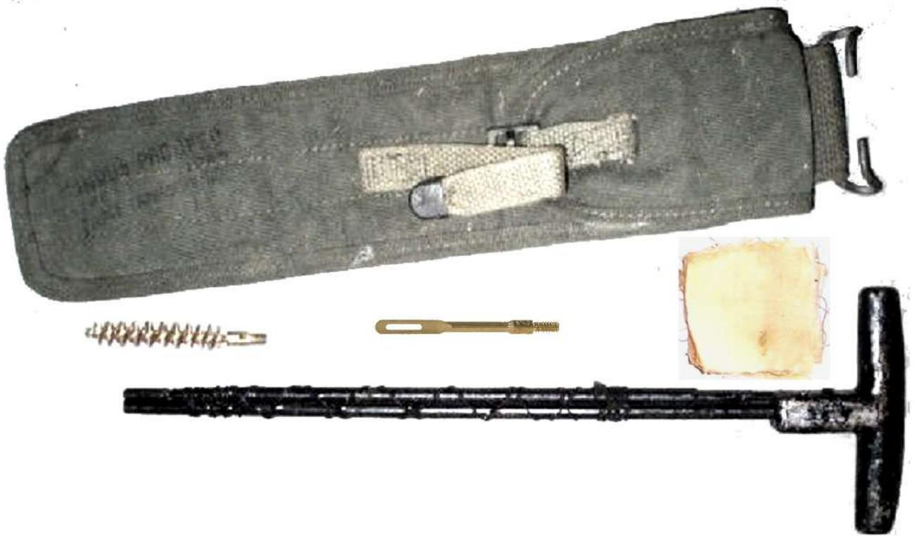
Trousse en toile pour nécessaire de nettoyage du canon des carabines U.S. tous types, comprenant une baguette en deux éléments, un écouvillon brins laiton, un lavoir en laiton et un jeu de spots (chiffons calibrés en tissu carré).
