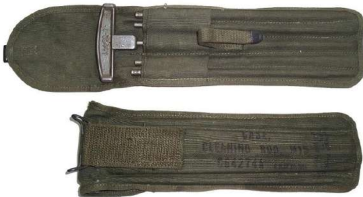
Baguette de nettoyage en 5 éléments dans sa housse de transport en toile.
