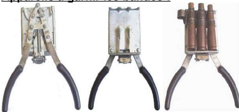
Appareil à main M12 pour couper ou assembler une bande
