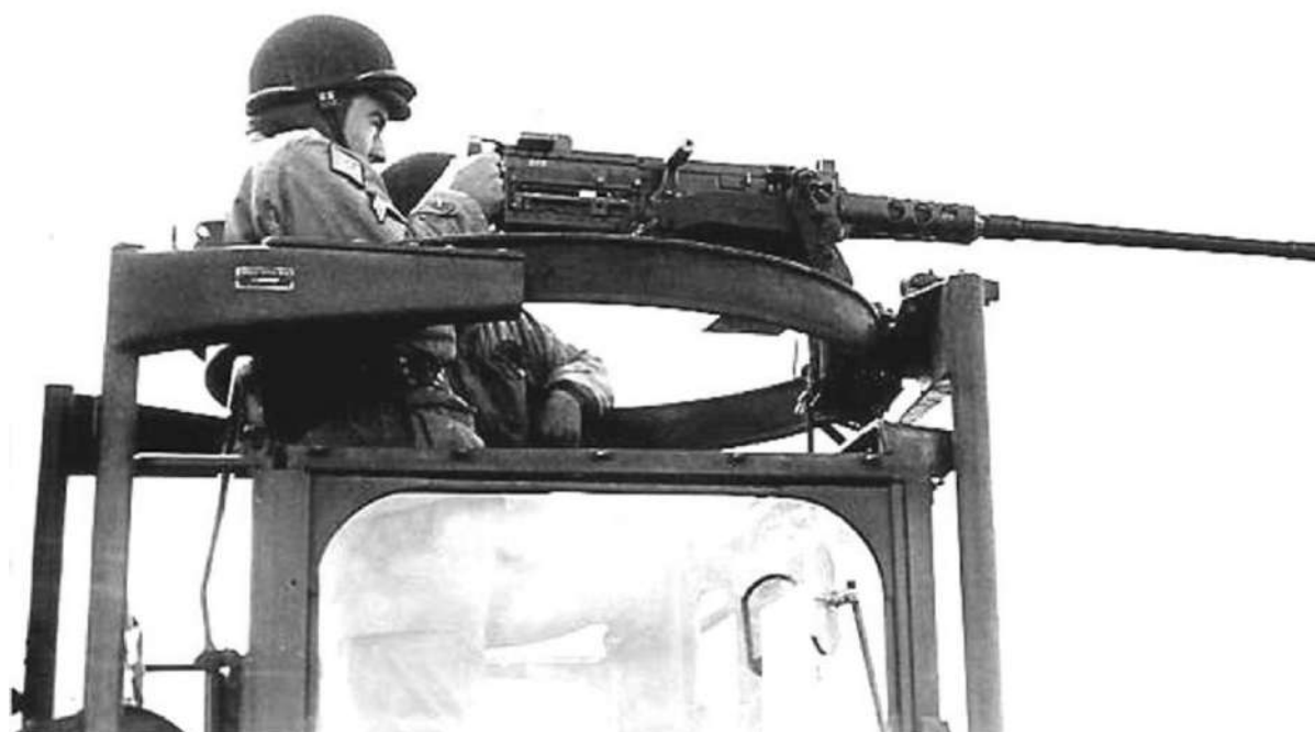
L'auteur au tir longue distance sur son Berliet de dépannage Lot 7 GBC 8 KT. L'arme est montée sur un affût tourelleau U.S. M 36 de camion GMC (CCKW 353) MF 65 ( M odifié F rançais en 19 65 ) pour être monté sur ce type de véhicule.
