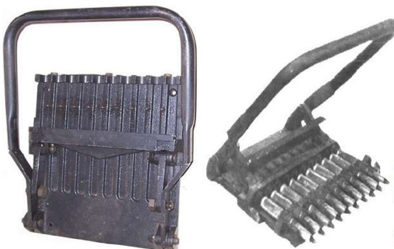
Appareil US M7 de garnissage et de dégarnissage de bande
