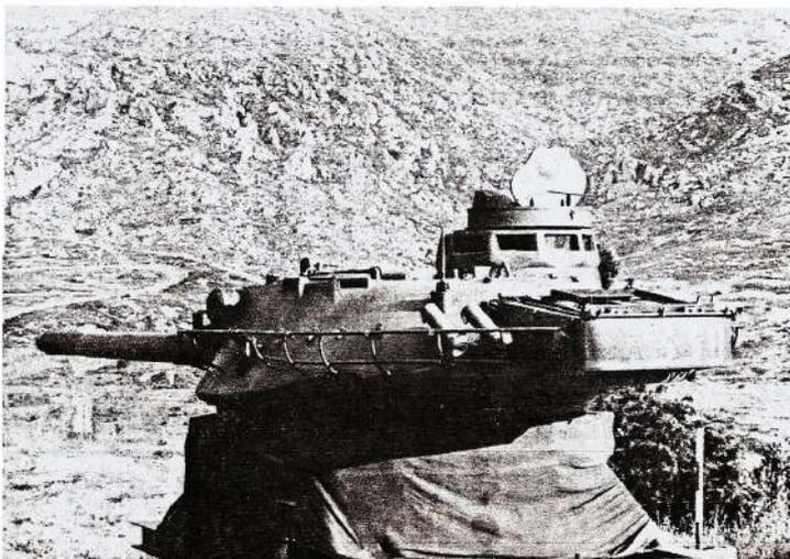
Le cycle de formation des tireurs sous tourelle sur char A.M.X. 30 comporte l'exécution de tirs réduits à distance réelle. Ceux-ci sont réalisés à partir d'une arme automatique A.A. 52 ou N F1 type C1, utilisée en coaxiale à la place de la mitrailleuse de 12,7mm.
