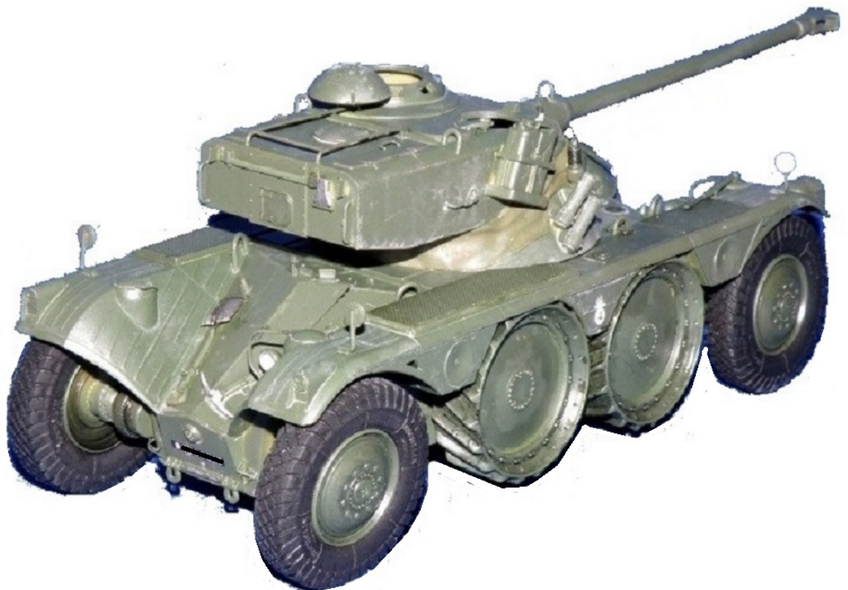
EBR M 49 tourelle FL 10 à canon de 75 mm SA 50, 3 mitrailleuses de 7,5 mm M.A.C. 31 E alimentation à gauche. Vue \frac{3}{4} arrière du compartiment de l'inverseur, un seul phare sur l'aile gauche.
