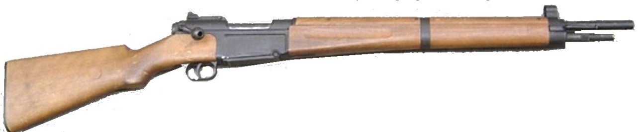
M.A.S. 36 1 er modèle , bouclerie laiton, oreilles protégé guidon et grenadière droite.
