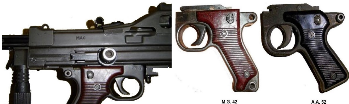
Une poignée de M.G. 42 montée sur une A.A. 52 en début de série.
